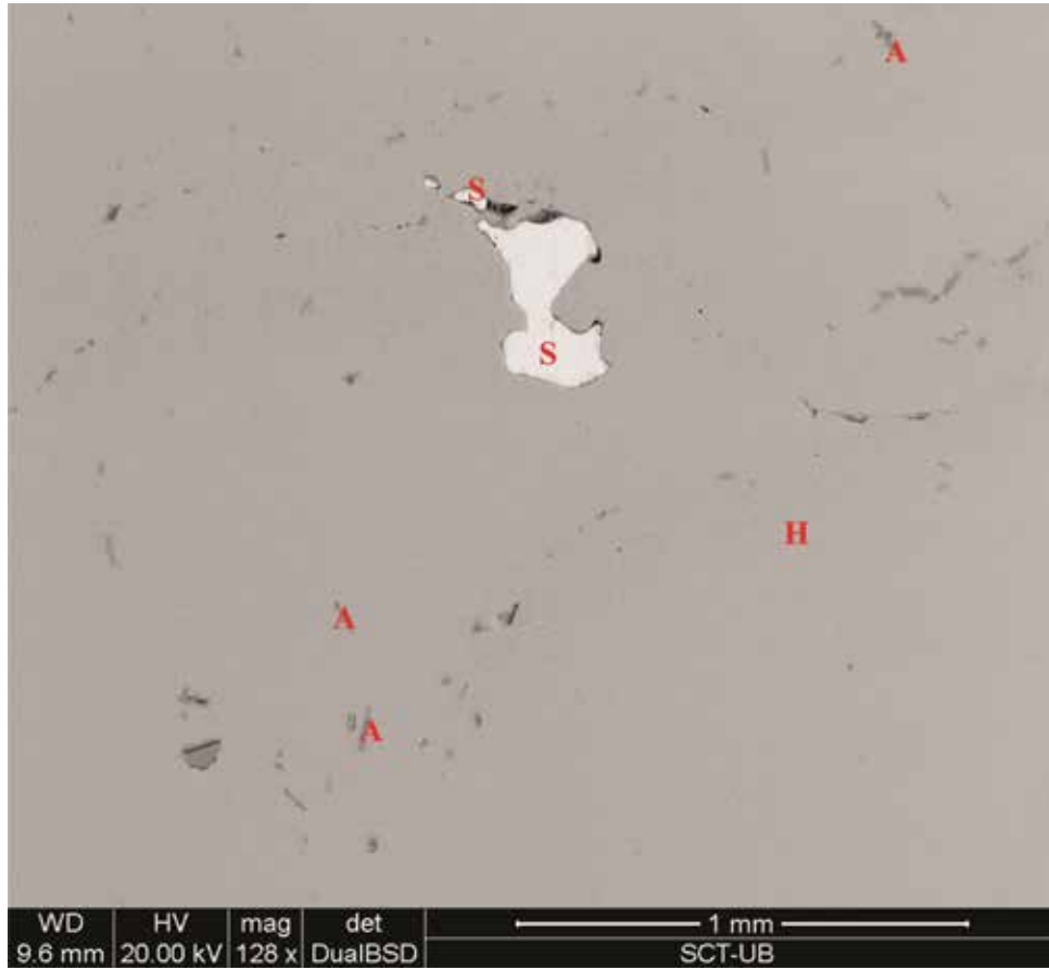
Şekil 27, 28 Sulha Üyesi'nden alınan Tuzların SEM görüntüleri (A: anhidrit, H: halit, K: karnalit, S: silvinit).
